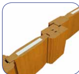
tloušťka zárubně dveří zarovnána s tloušťkou nadsvětlíku
