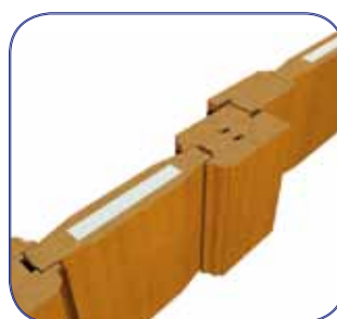
tloušťka zárubně dveří zarovnána s tloušťkou nadsvětlení
